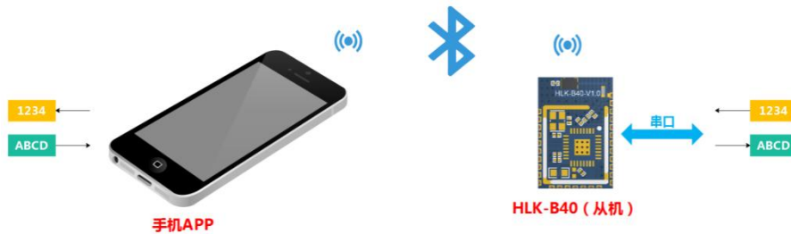
图 4 一对一蓝牙连接透传功能示意图
